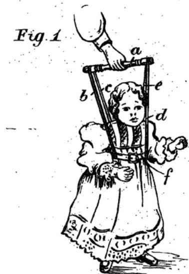
Brevet britannique n° GB191302966A , Improved Means for Supporting a Child when Learning to Walk, 5 février 1913
